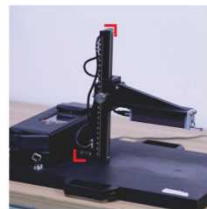
产品型号: KTLW40-L250 轴 向: Z轴 应用场 景: 粗糙度仪的上下调整
