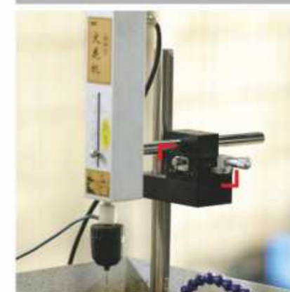
产品型号: KTLY60-CM 轴 向: XY轴 应用场 景: 火花机的位置调整
